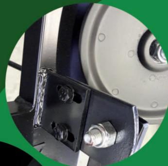
Support de bras réglable, poulie renforcée à roulements à bille
