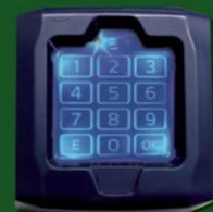
Clavier numérique à effleurement à code tournant
